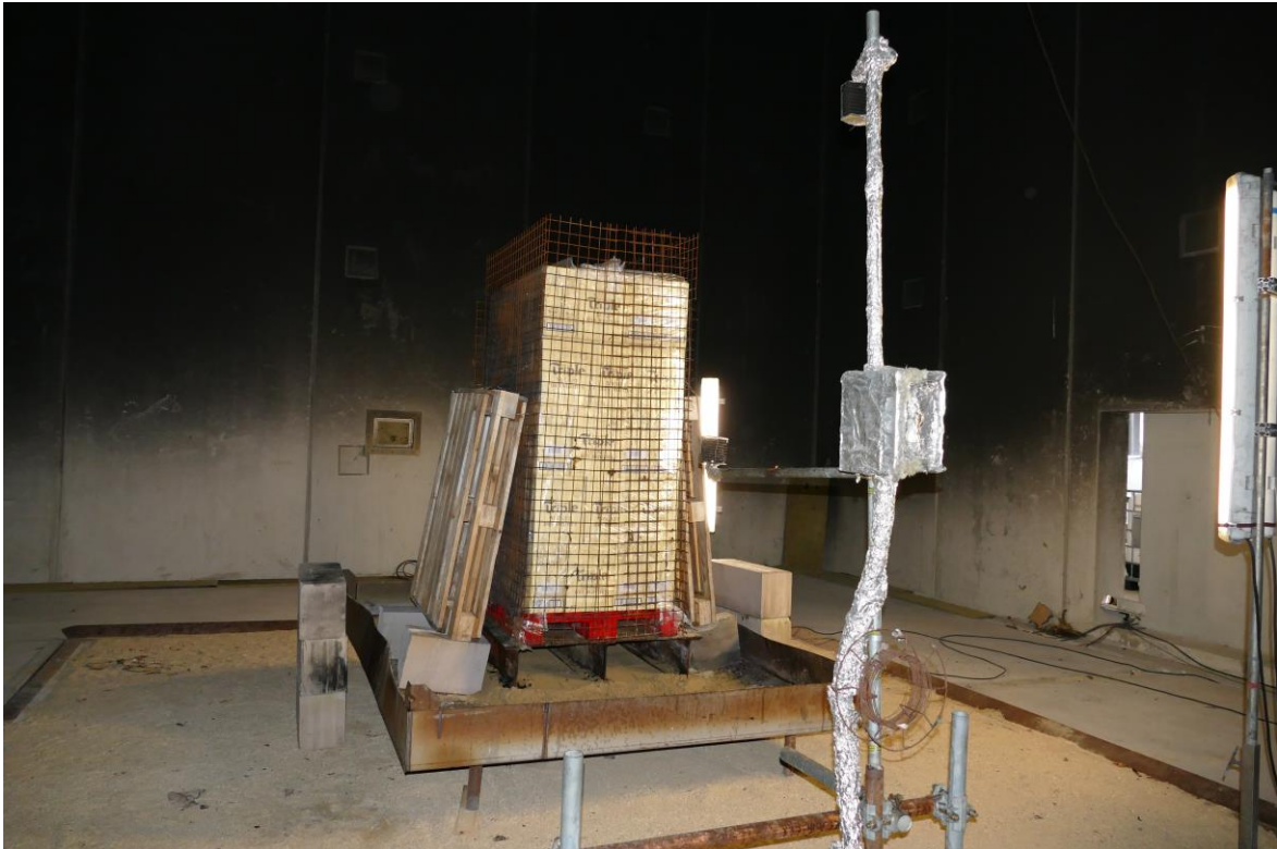
Figure 7 : Photographie présentant l'installation de l'essai N°3
